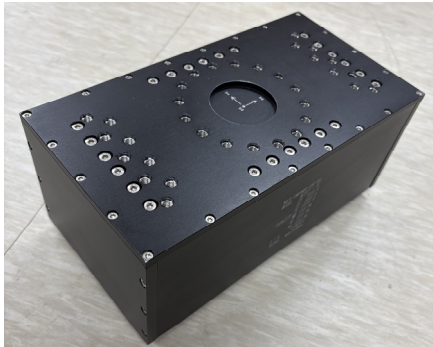
Fig. 6 6-component sensor ( F_x=F_y=3000\text{N} , F_z=12000\text{N} , M_x=1000\text{N}\cdot\text{m} , M_y=M_z=2000\text{N}\cdot\text{m} )
