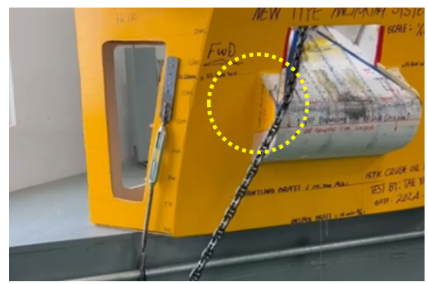
(d) Detachment check of anchor
