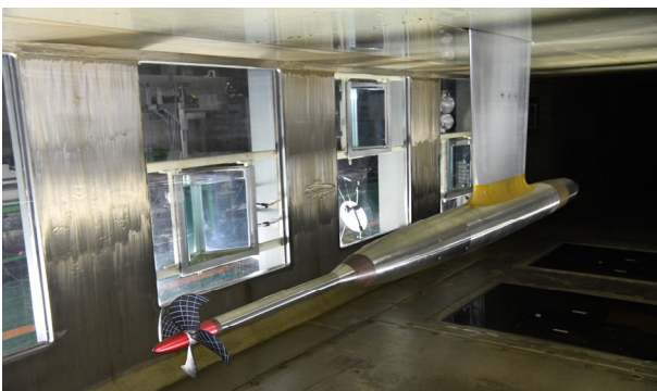
Fig. 1 H41 dynamometer for POW test
